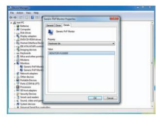
► Falls mehr als ein Gerät *Generic PnP Monitor* angezeigt wird, prüfen Sie, ob das richtige Gerät ausgewählt ist.
